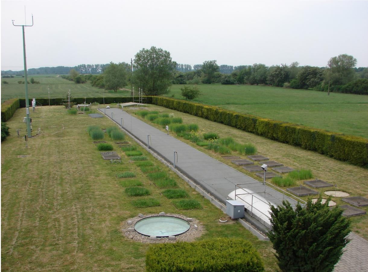
Lysimeterstation des UFZ in Falkenberg
