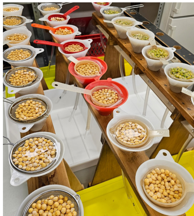
Untersuchung von Erbsenproben mittels Baermann-Trichter
