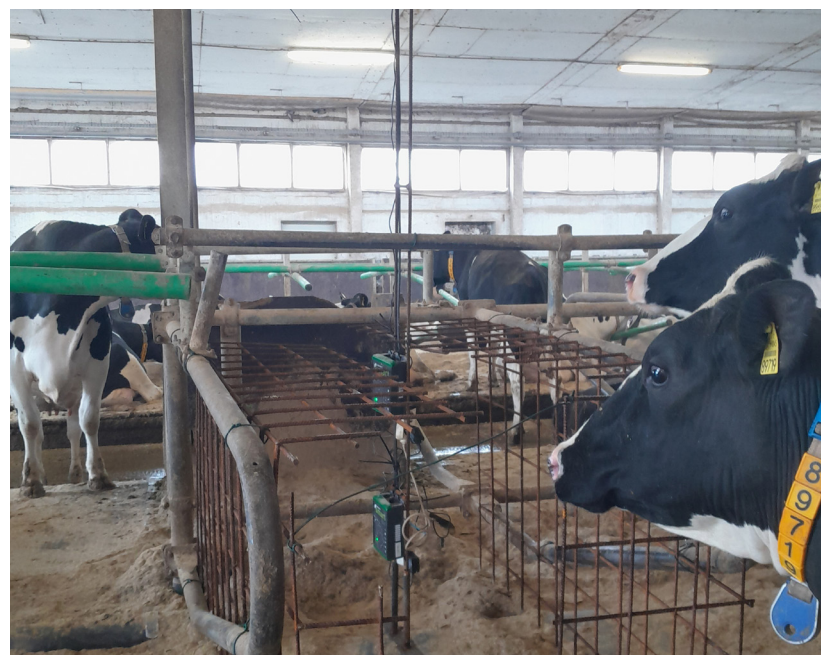
Versuchsaufbau Sensoren zur Messung von Stall- klimaparametern in 0,5 m, 1,0 m und 2,5 m Höhe im Milchviehstall
