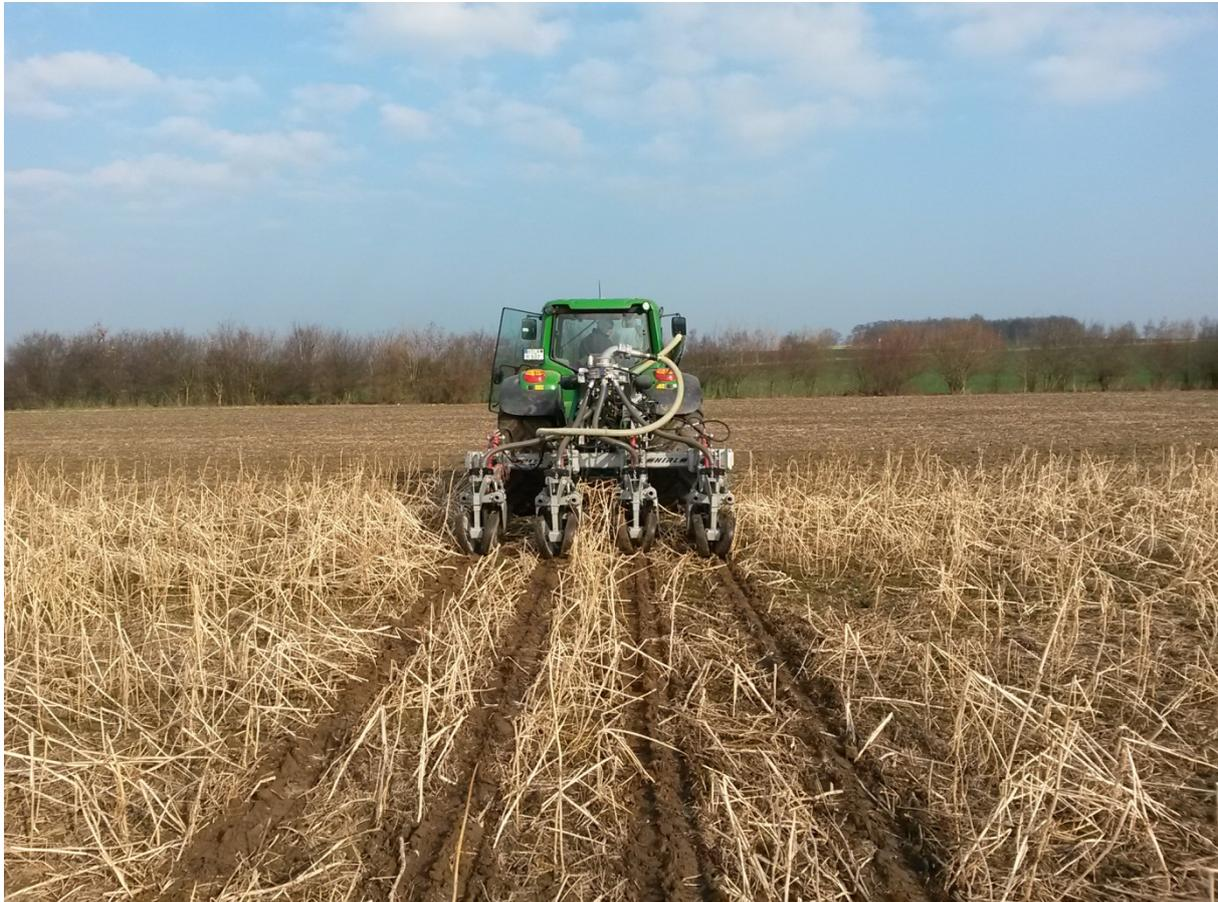
**Abb. 1: Gülleausbringung im Frühjahr 2015 im ST-Verfahren in den abgefrorenen Zwischenfruchtbestand**
