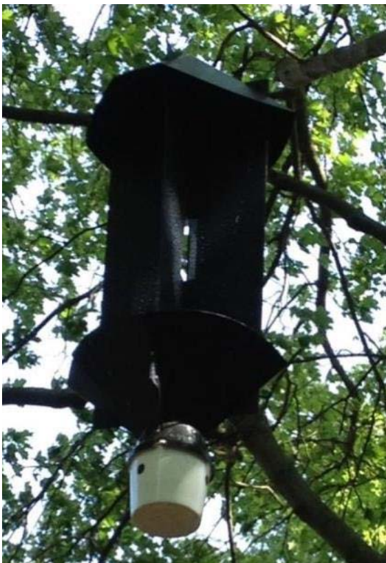
Pheromon- oder Lockstofffalle zur Überwachung des ALB (Quelle LLG)
