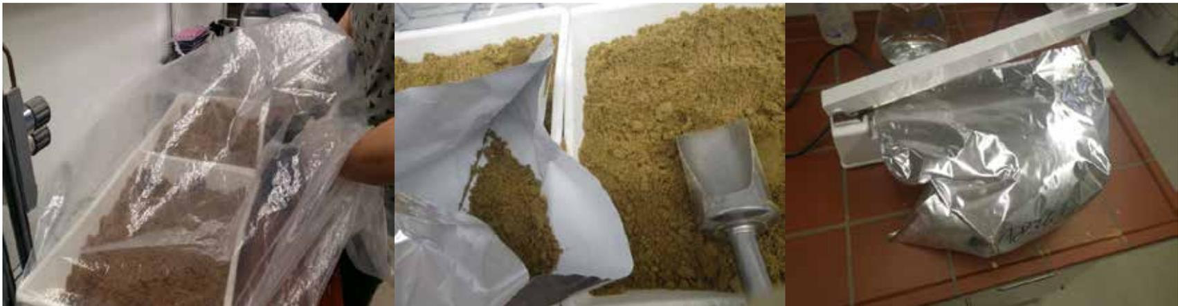
Abbildung: Herstellung im Glovebag (links), Abfüllung in gasundurchlässige Beutel (mitte) und Versiegelung der Beutel (rechts)
