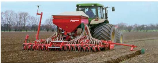
Abbildung 2: Kreiselegge-Drillmaschinenkombination; Bildquelle: BISCHOFF
