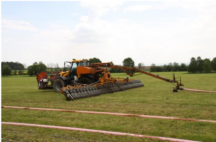
Die Pumpstation wird vom Ausbringer per Fernbedienung gesteuert. Beim Wendemanöver wird die Pumpendrehzahl reduziert und der Güllefluss über einen Bypass in das Lager zurück gepumpt.
