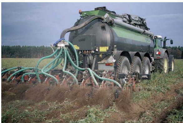
Abbildung 31: Streifenbearbeitung in Verbindung mit Gülleinjektion
