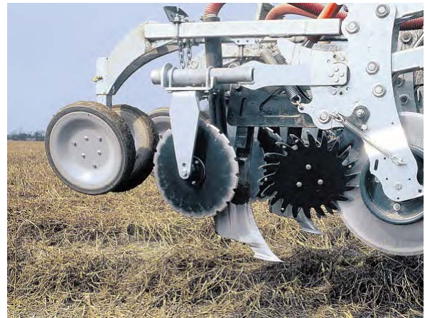
Abbildung 32: Arbeitswerkzeuge bei der Streifenbearbeitung: ein vorlaufendes Schneidsech, Räumsterne, schmale Lockerungszinken mit gezackten Hohlkreisen sowie V-Andruckrolle
