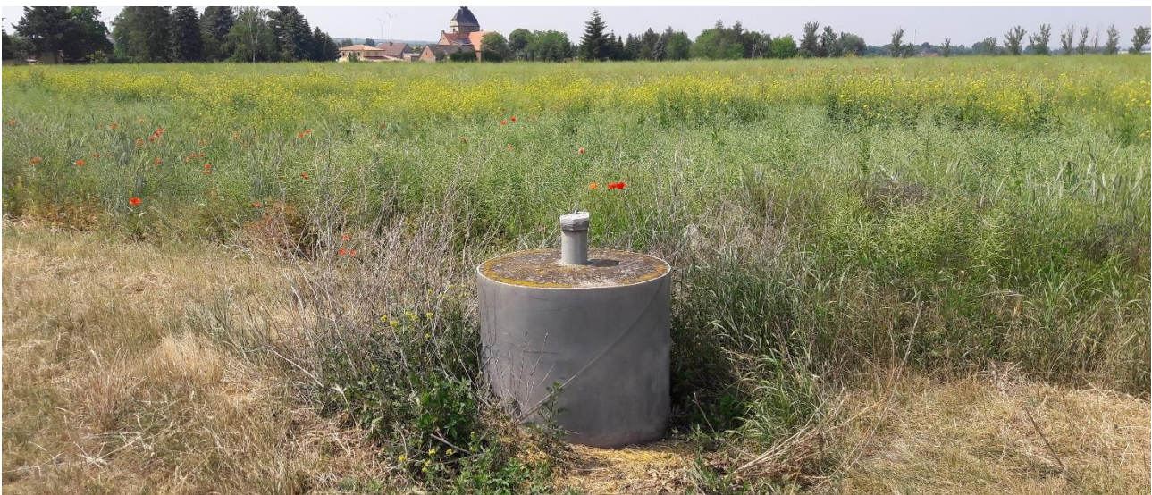
Abb. 19: Grundwassermessstelle Steden mit Blick in Richtung des Zustroms (eigene Aufnahme vom 31.05.2018)
