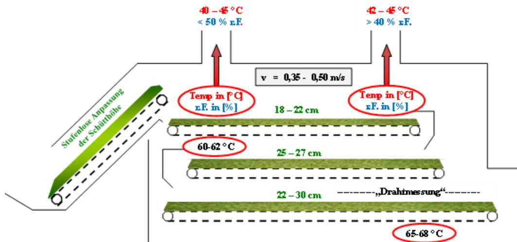
Abb. 4: Messpunkte und mögliche Grundeinstellungen beim Bandtrockner
