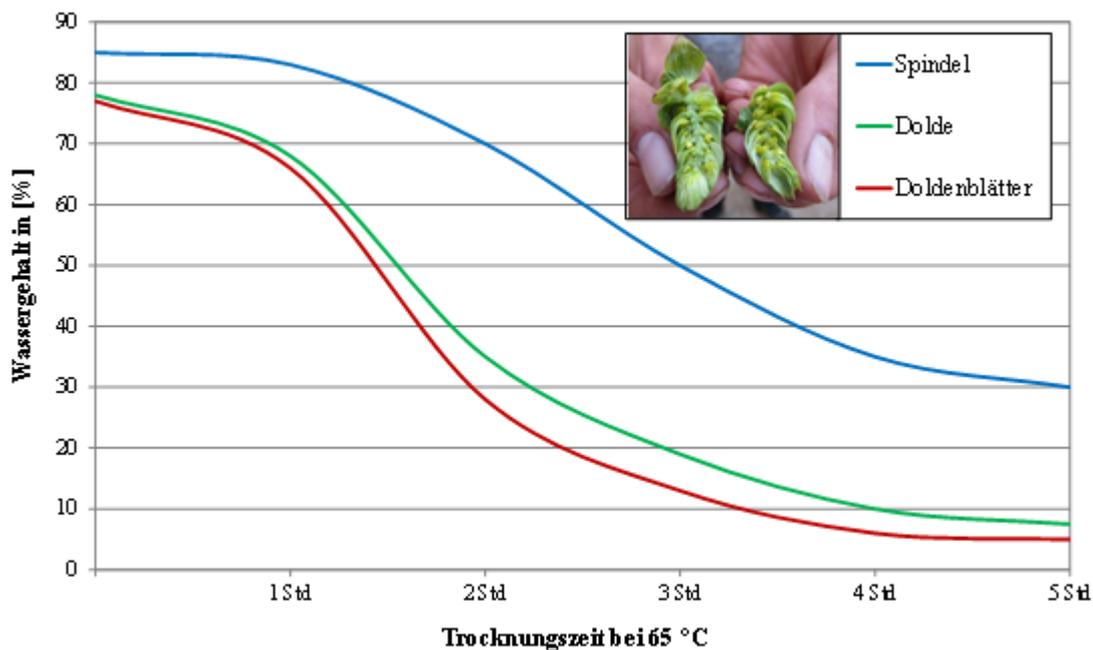
Abb.1: Wassergehaltsabnahme während der Trocknung von Dolde, Spindel und Doldenblättern in einer Kleintrocknungsanlage
