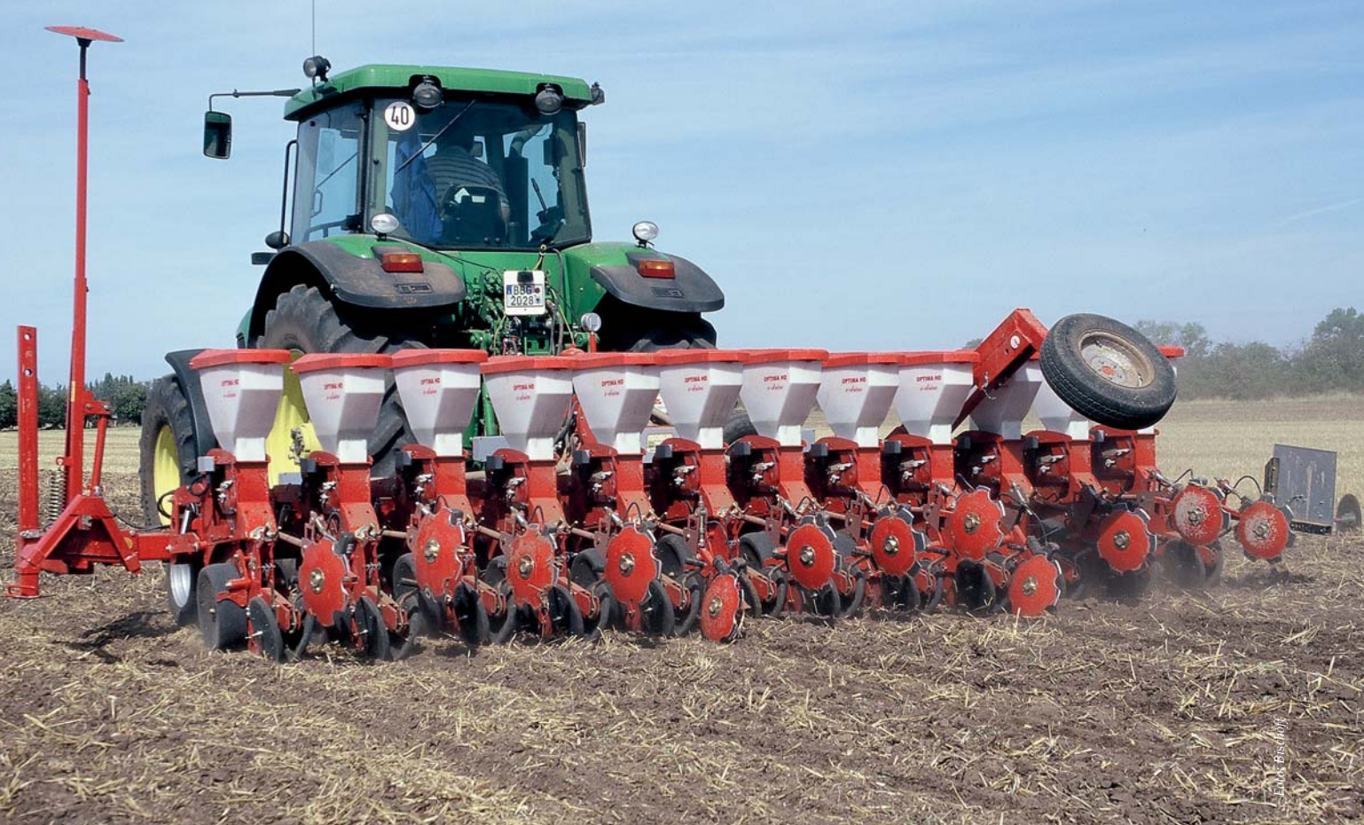
Einzelkornsaat von Winterraps mit der pneumatischen Einzelkornsämaschine Accord Optima.
