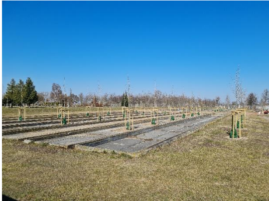
Versuchsanlage " wassergebundene / wasserdurchlässige Baumscheibenbeläge
