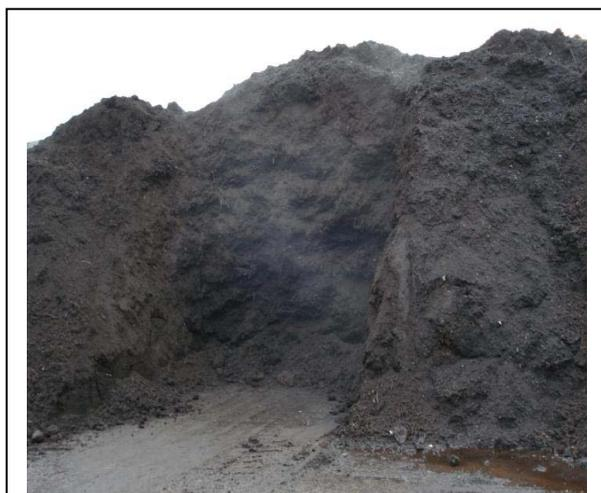
*Abbildung 12: Probenahmeanschnitt für die Beprobung organischer Düngemittel*
