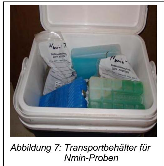
Abbildung 7: Transportbehälter für N<sub>min</sub>-Proben
