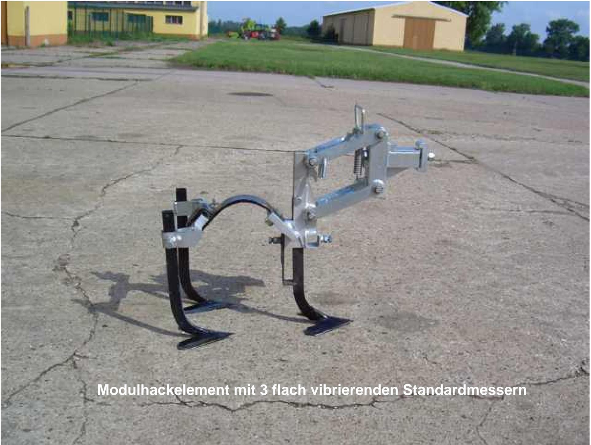
**Modulhackelement mit 3 flach vibrierenden Standardmessern**
