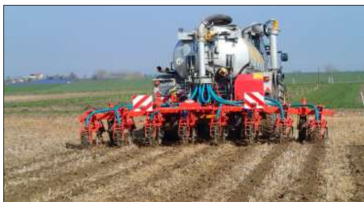
Abbildung 11: Streifenbearbeitung mit Kuhn Striger, Lüttewitz 2014.
