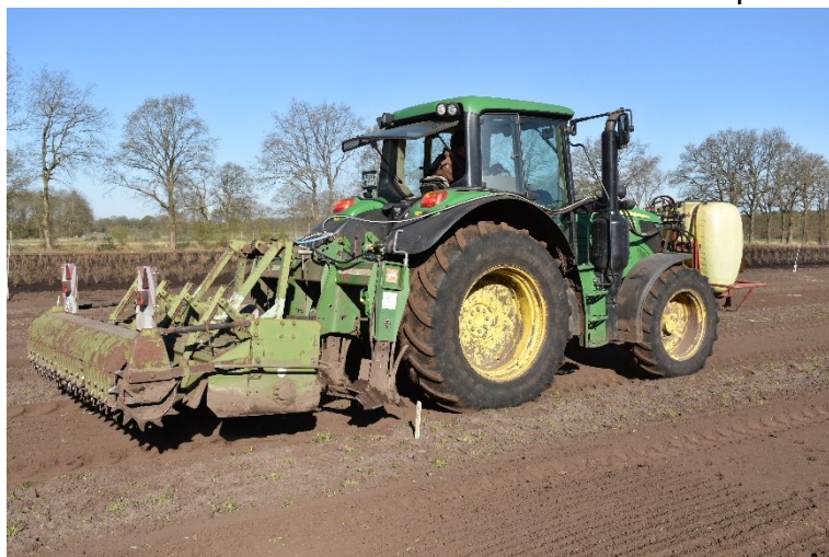
Nicht nur Obstbaubetriebe sollten die Applikation von KarDox TERRAM im Nachbau von Apfel kritisch hinterfragen - hier eine Gerätekombination zur Applikation des Desinfektionsmittels beim Einsatz im Versuch der LKSH
