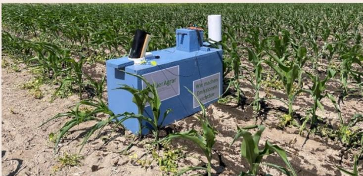
Bild 3: Ammoniakgasmessung (Quelle: LLG)
