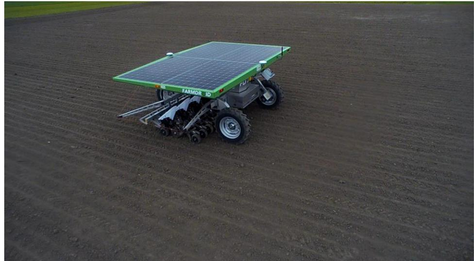
Der FD 20 wird elektrisch angetrieben und erzeugt die Energie über PV-Module. Die Arbeitsgeschwindigkeit beträgt 450 bis 950 m/h. Damit ist eine Flächenleistung von ca. 20 ha/ Einheit leistbar (Herstellerangabe)
