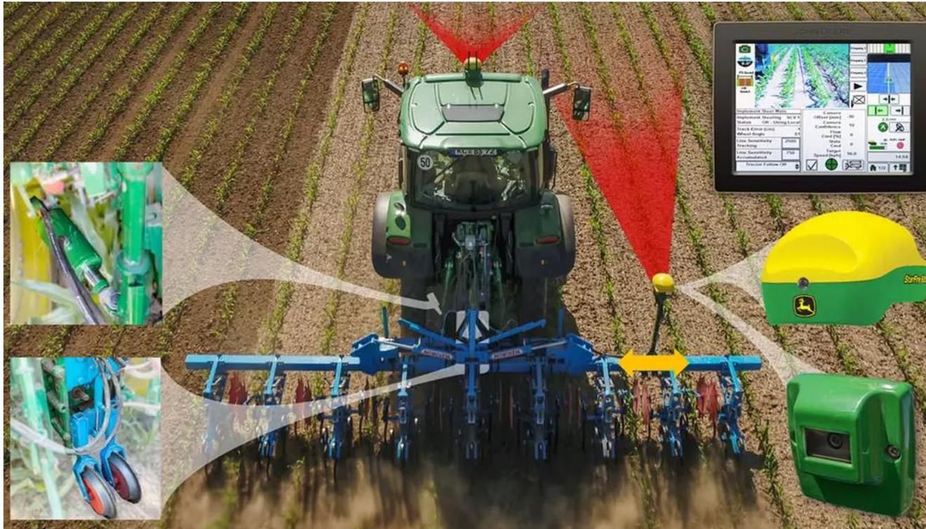
Ackerschlepper auf einer Hacke implementierte Werkzeugsteuerung (Reihenerkennung und Rahmenverschiebung)
